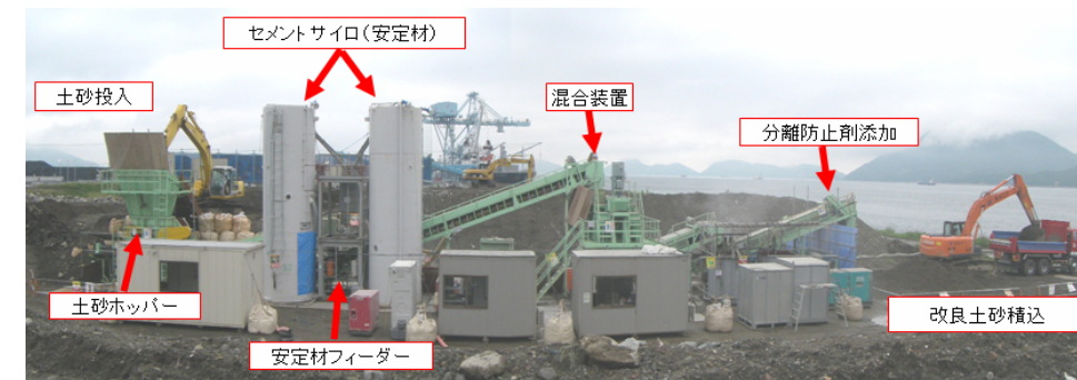
陸上事前混合処理設備全景
